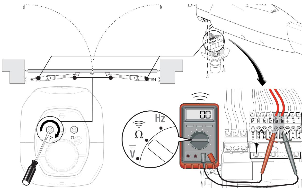
После регулировки крайних положений выполните автоматическое определение крайних положений хода с помощью блока управления, следуйте инструкциям в руководстве блока управления.
