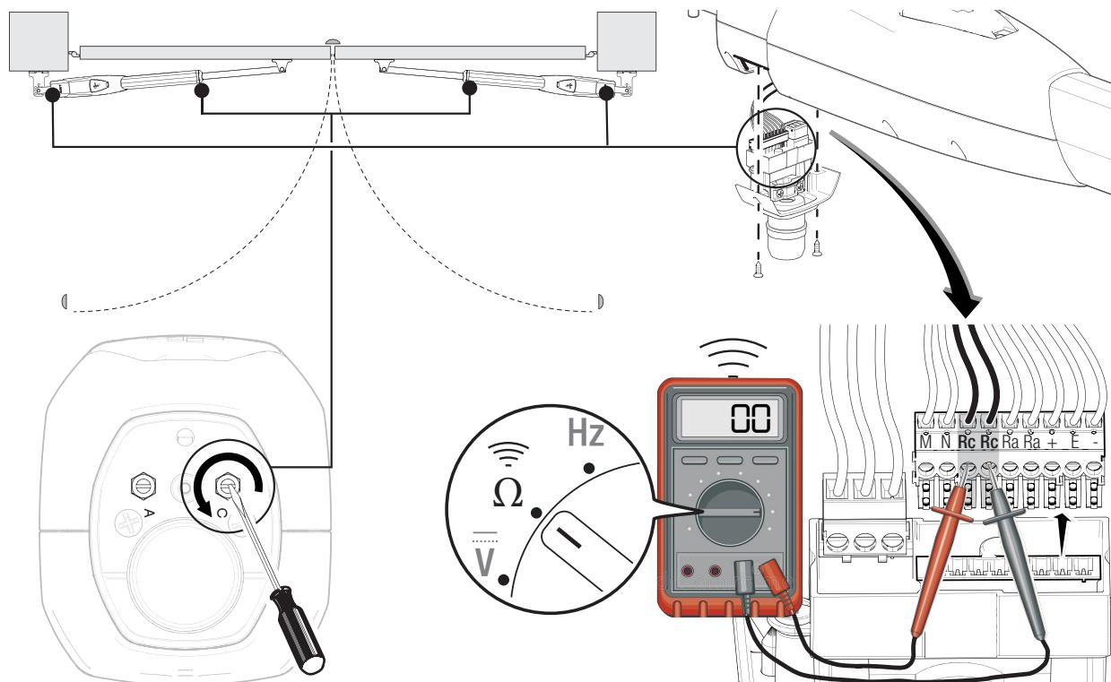
После регулировки крайних положений выполните автоматическое определение крайних положений хода с помощью блока управления, следуйте инструкциям в руководстве блока управления.
